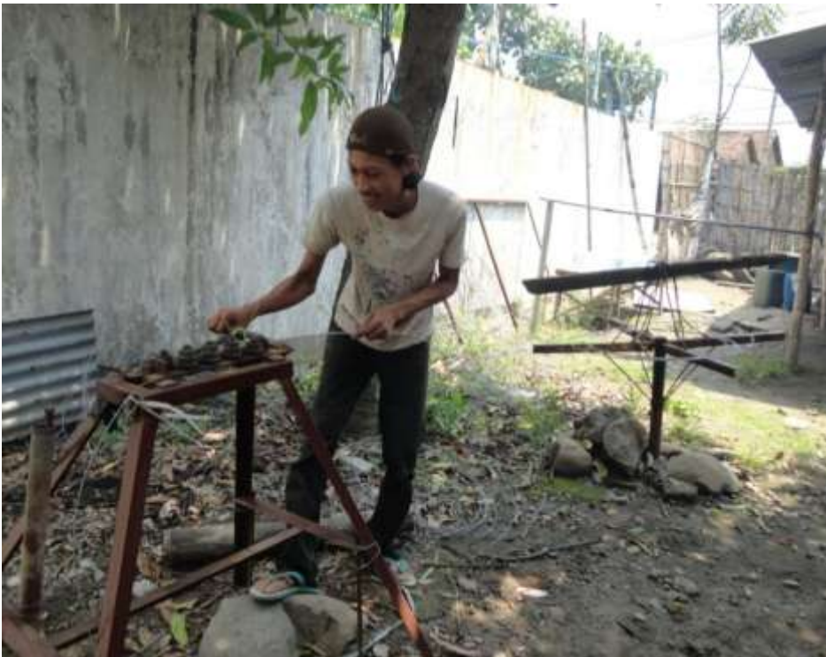
Gambar 5.1.. Proses Pelurusan Kawat Pertama
