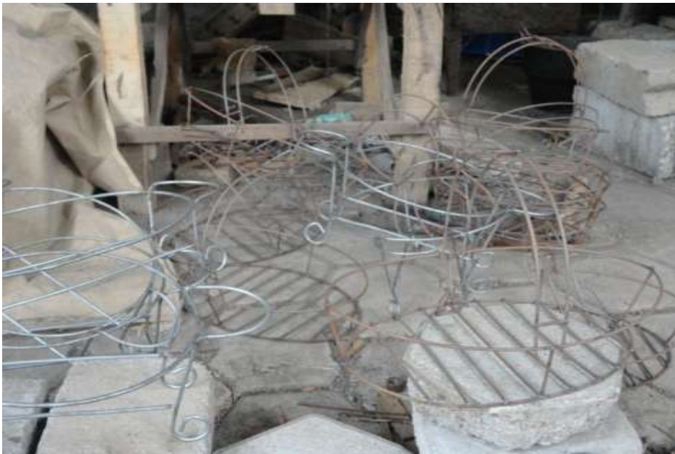
Gambar 5.12. Produk Setengah Jadi Setelah Pengelasan
