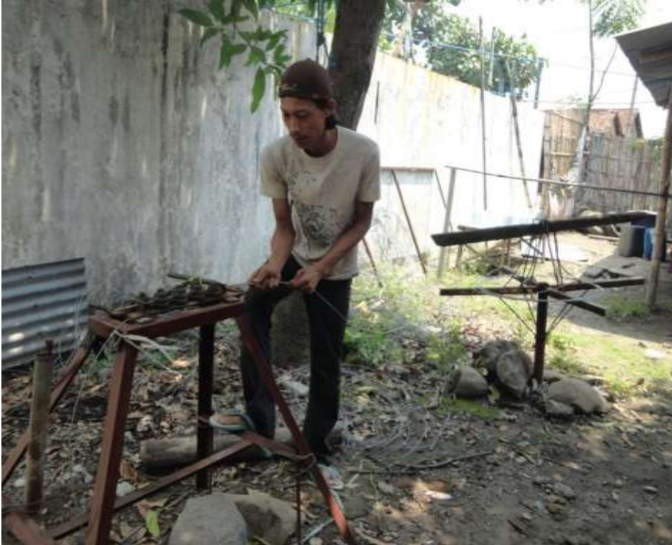
Gambar 5.2. Proses Pelurusan Kawat Kedua
