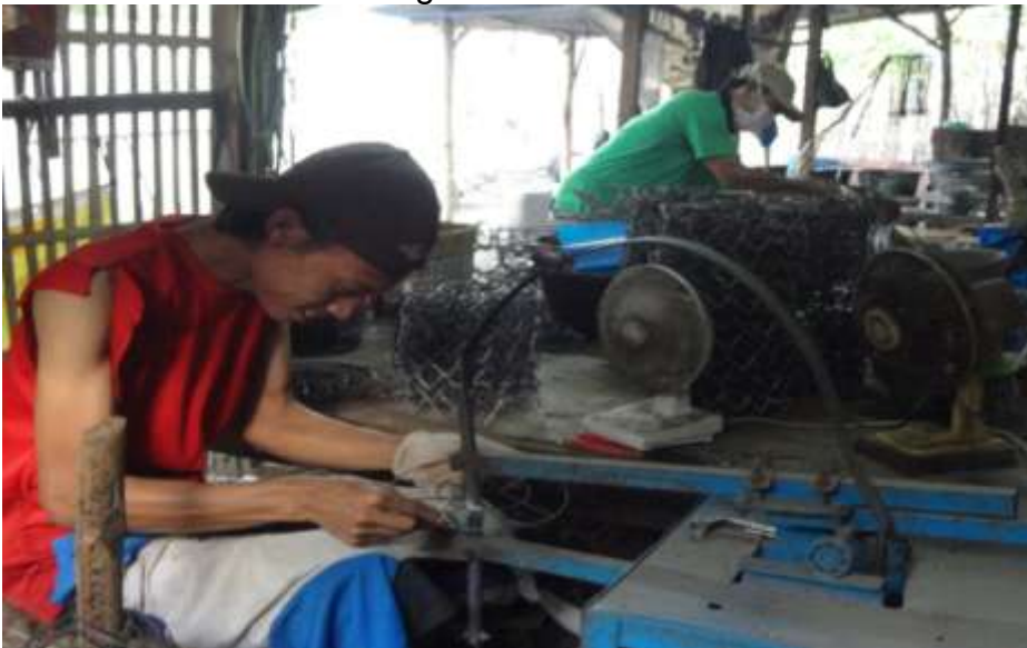
Gambar 5.11. Proses Pengelasan Alas Panci
